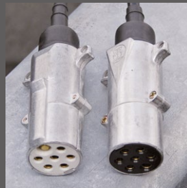
2 x 7-poliger Stecker inkl. Verbindungskabeln
