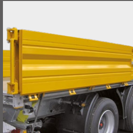
1-teilige Rückwand als Türflügel
