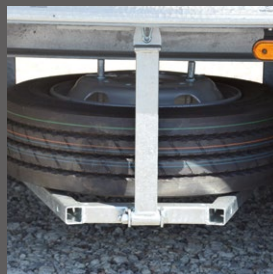
Ersatzradhalter als Korb unter der Ladefläche
