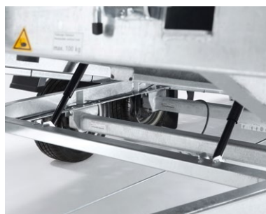
Brücke mit speziellem Kipplager
