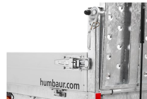
Tauchbad feuerverzinkte Eckungen und Spannverschlüsse
