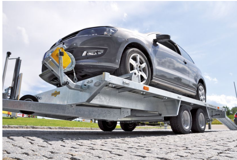
Stabiler Grundrahmen aus gekanteten Stahlprofilen
