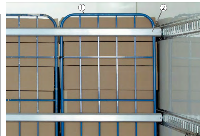
Abb. 178 Beispiel: Ladung mittels Sperrbalken gesichert
