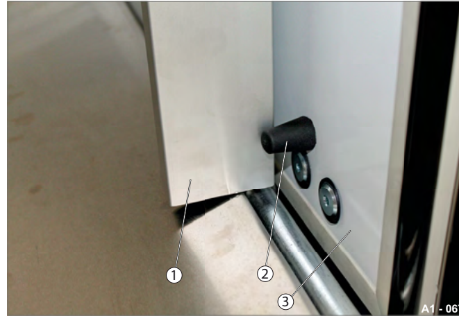
Abb. 135 Überfahrbrücke seitlich sichern
