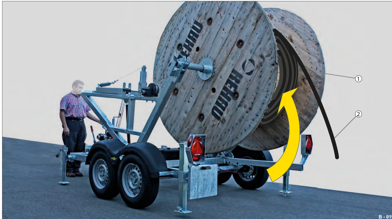
Abb. 16 Trommelgestell heben / Kabel bedienen
